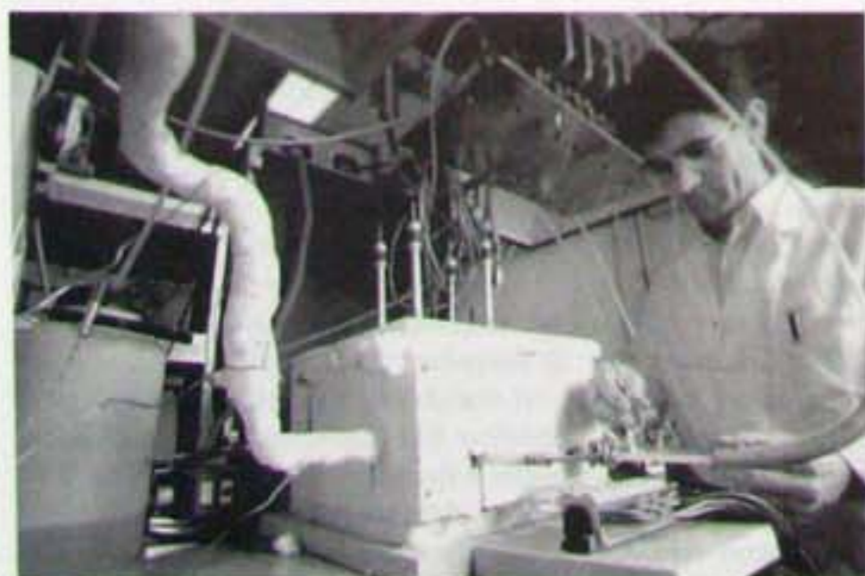
Cella a combustibile a carbonati fusi, di fabbricazione Ansaldo Ricerche. In primo piano, il tubo termostato di adduzione del combustibile umidificato.
