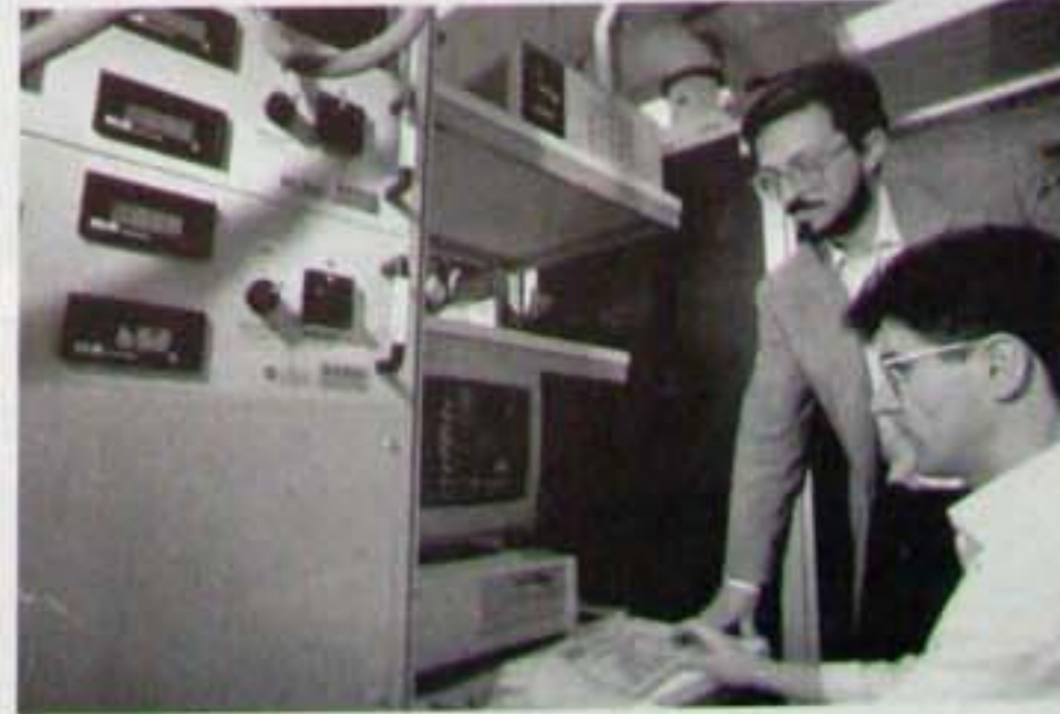
Roberto Fezzi e Mauro Scagliotti ai sistemi di controllo per l'esercizio e la caratterizzazione elettrica di celle a combustibile a carbonati fusi.
