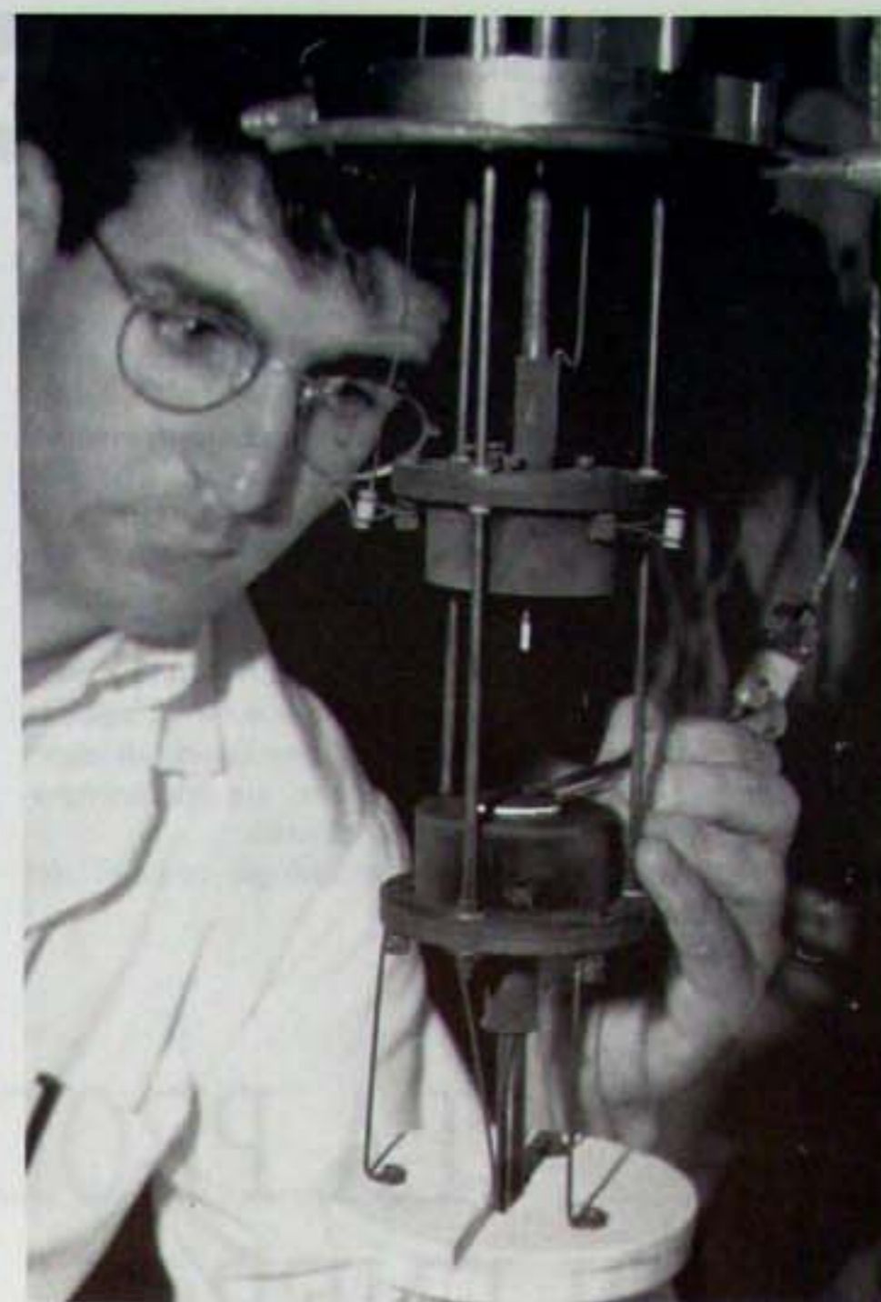
Roberto Fezzi durante la fase di montaggio dei componenti attivi della semicella a combustibile a carbonati fusi.
